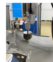
プライマー塗布
