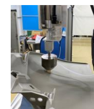
プライマー塗布
