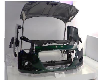
植物由来の樹脂を多用したコンセプトモデル 人とくるまのテクノロジー展2023に出展
